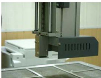
ИК-датчик на корпусе верхнего нагревателя Quick 2035
