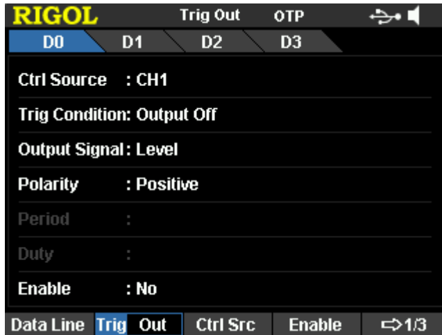
Рис. 0-10 Интерфейс настройки выхода триггера
