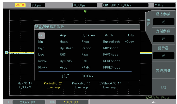
Измерение параметров, выбранных пользователем
