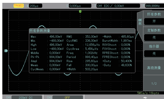
Интерфейс одновременного измерения всех параметров
