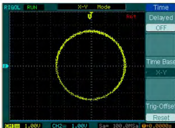
Рисунок 3-17 Сигналы каналов имеют сдвиг фазы 90^\circ (фигура Лиссажу) Сдвиг фазы 90^\circ , фигура Лиссажу в виде окружности.
