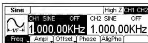
Рисунок 3-13 Настройки одинакового сигнала синуса в обоих каналах генератора CH1 и CH2
