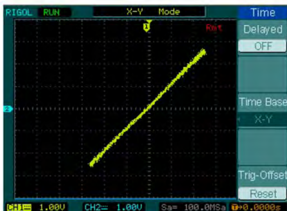
Рисунок 3-15 Проверка идентичности сигналов по Лиссажу
